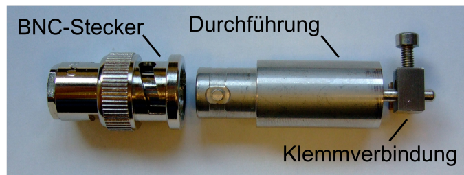
Abbildung 4.49: Durchführung mit BNC-Stecker und Klemmverbindung.
