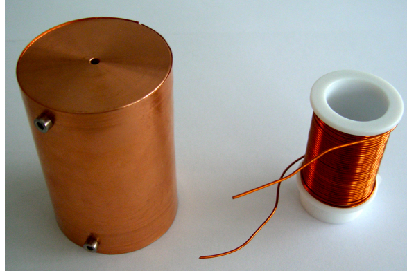
Abbildung 4.16: Abschirmgehäuse aus Kupfer und Spulenkörper mit Kupferdrahtwicklung.
