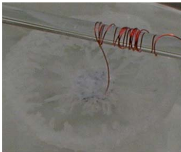
Abbildung 3.3.20: Ca(OH)_2 -Synthese mit 52,6 ppm Citronensäure nach 40 Tagen
