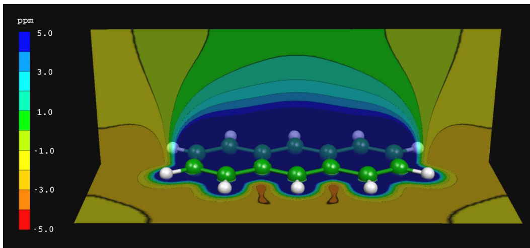
Abbildung 4.2: Darstellung der kernunabhängigen chemischen Verschiebungen (siehe Text) für Anthracen. Ringströme im aromatischen System verursachen eine positive Abschirmung.
