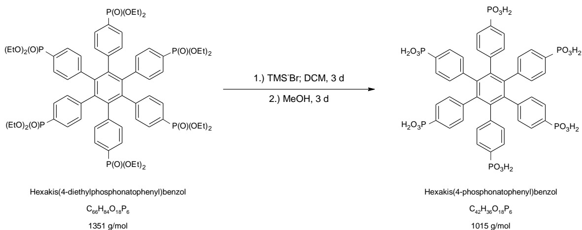
Abbildung 42: Dritter Reaktionsschritt in der Synthese von p-PA-HPB: Synthese von Hexakis(4-phosphonatophenyl)benzol.
