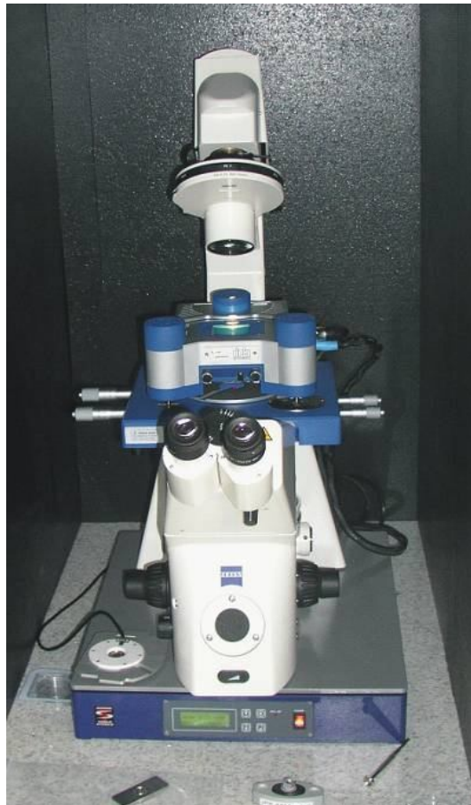
Abbildung 4.5: verwendetes Rasterkraftmikroskop „Nanowizard“ der Firma JPK Instruments
