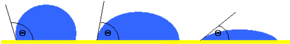
Abbildung 5: Kontaktwinkel von Wasser auf einer sehr hydrophoben (links), gut benetzenden (Mitte) und einer sehr hydrophilen Oberfläche (rechts)
