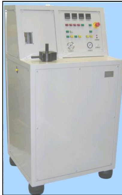
Abbildung 8: Darstellung des Hochdruckgefrierers HPF Compact 01 [27] .
