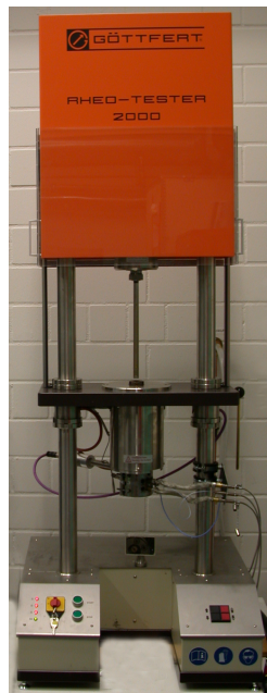
Abbildung 3.1: Kapillarrheometer: Goettfert Rheotester 2000.
