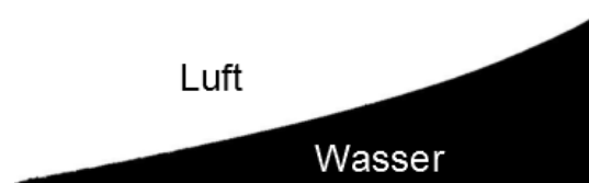
Abbildung 4.22: Bearbeitetes Profil des Meniskus bei 7,9 \frac{\text{mm}}{\text{s}} bei der Entnetzung von Wasser auf PS.
