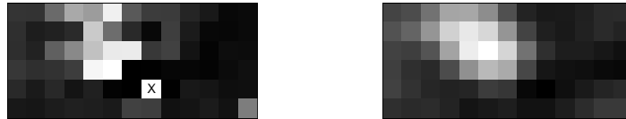
Abbildung 4.17: Spannweiten \max(\mathcal{Y}_{\kappa(\mathbf{x}(t))}^L) - \min(\mathcal{Y}_{\kappa(\mathbf{x}(t))}^L) der Ausgabegröße Y (tägl. Abfluss des Breitenbaches an „Haus B“) für die zugehörigen Einzugsgebiete der SOM-Neuronen in den Lerndaten (links; anstatt durch die voreingestellte Beschriftung „ndef“ wurde hier wegen der verkleinerten Grafik ein X zur Kennzeichnung nicht definierter Werte verwendet) und durch Graustufen repräsentierte Ausgaben des RBFNs bei der Eingabe der jedem SOM-Neuron zugeordneten Kodebuchvektoren (rechts).
