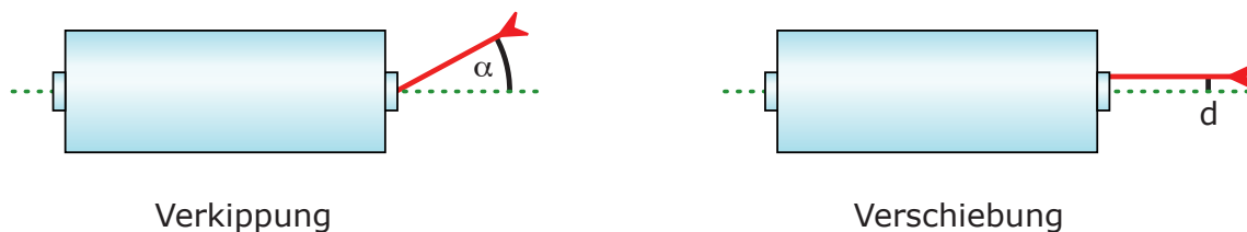
Abbildung 5.5: Strahllagefluktuationen an einem optischen Resonator lassen sich in Strahlverkippung und Strahlverschiebung relativ zum Eigenmode des Resonators, angedeutet durch die grüne Punktlinie, aufteilen.
