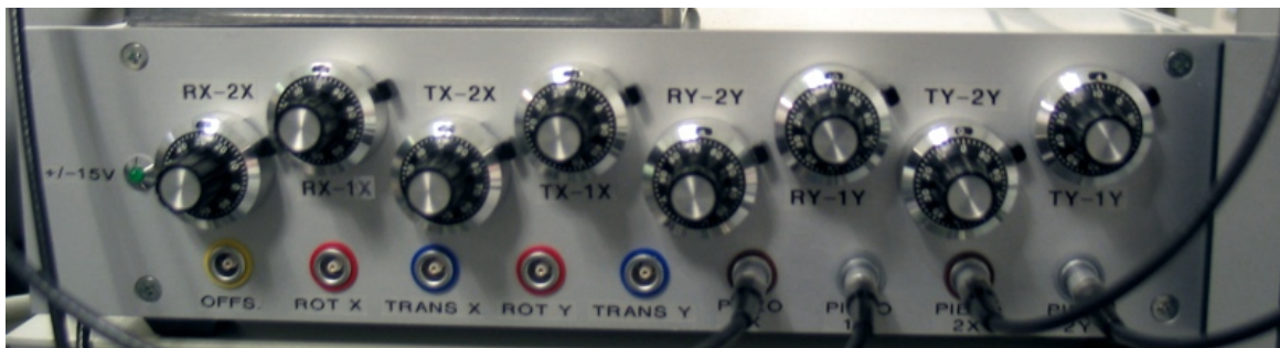
Abbildung 5.11: Orthobox: An die Eingänge ROT X , Y und TRANS X , Y kann über einen Frequenzgenerator definiert in X- oder Y-Richtung verkippt ( ROT ) oder verschoben ( TRANS ) werden. Über die Potentiometer werden die Signale dazu entsprechend auf die Piezo-Spiegel verteilt.
