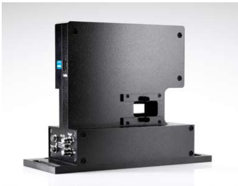
Abbildung 3.3: Der Flüssigkristallmodulator SLM-S320 [JEN11].
