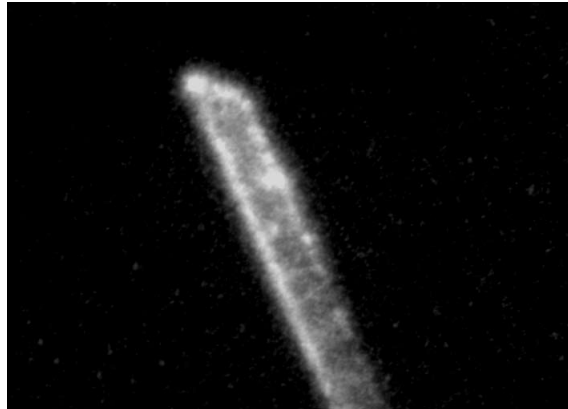
Abbildung 2.18: CCD-Kameraaufnahme der Glasfaser im Fallenzentrum. An solch einer Aufnahme wird die Vergrößerung des optischen Systems bestimmt. Vibrationen der Glasfaserhalterung begrenzen hier die Auflösung.
