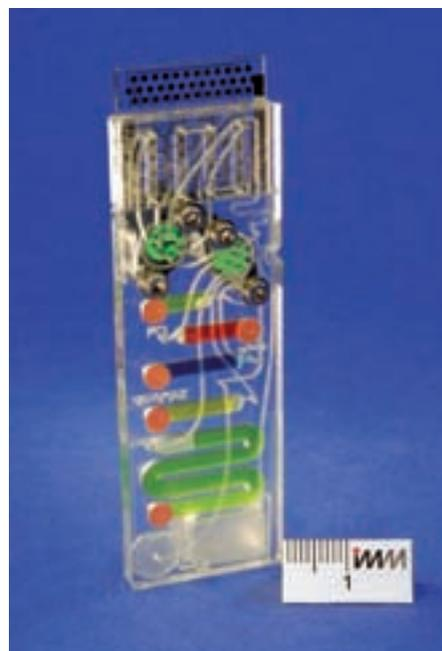
**Abb. 2:** Der elektrochemische Detektionschip des IMM ist als zweidimensionaler Elektrodenarray in elektrochemischen Detektionskammern ausgelegt.
