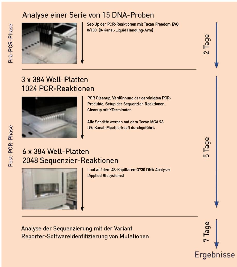
**Abb. 2:** Hochdurchsatzprotokoll zur Resequenzierung von BRCA1 und BRCA2 mit der Tecan Freedom EVO Liquid Handling-Station. Für die PCR-Probenvorbereitung wurde ein 8-Kanal-Liquid Handling-Kopf eingesetzt. Die PCR-Aufreinigung und die Vorbereitung der Sequenzierung erfolgten mit einem 96-Kanal-Pipettierkopf.
