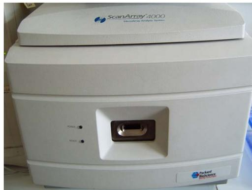
**Abb. 30:** Laserscanner ScanArray 4000 von Perkin Elmer. In die Einsparung an der Vorderseite wurde der jeweils zu scannende Microarray eingeführt.
