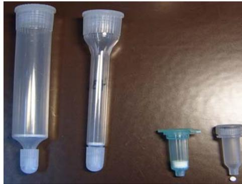
**Abb. 24:** Fotografie der verwendeten Filter-Röhrchen. Von links nach rechts: Filter-Röhrchen zur Befüllung mit Ni-NTA-Agarose (5 ml und 1 ml-Volumen), Qiagen SpinColumns gefüllt mit Ni-NTA-Agarose, MoBiTec SpinColumns zum Befüllen mit Ni-NTA-Agarose
