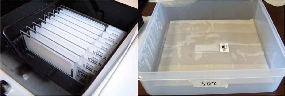
**Abb. 28:** Plastikgefäß zum Blocken und Waschen der Microarrays (links) und Box mit feuchtem Papier zum Generieren einer hohen Luftfeuchtigkeit während der Antikörper-Inkubationen (rechts).
