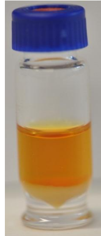
4.2. Bild: Reaktionsansatzes DPA mit DPPC, oranger Überstand: Benzenphase, weißer Niederschlag: TEA- HCl
