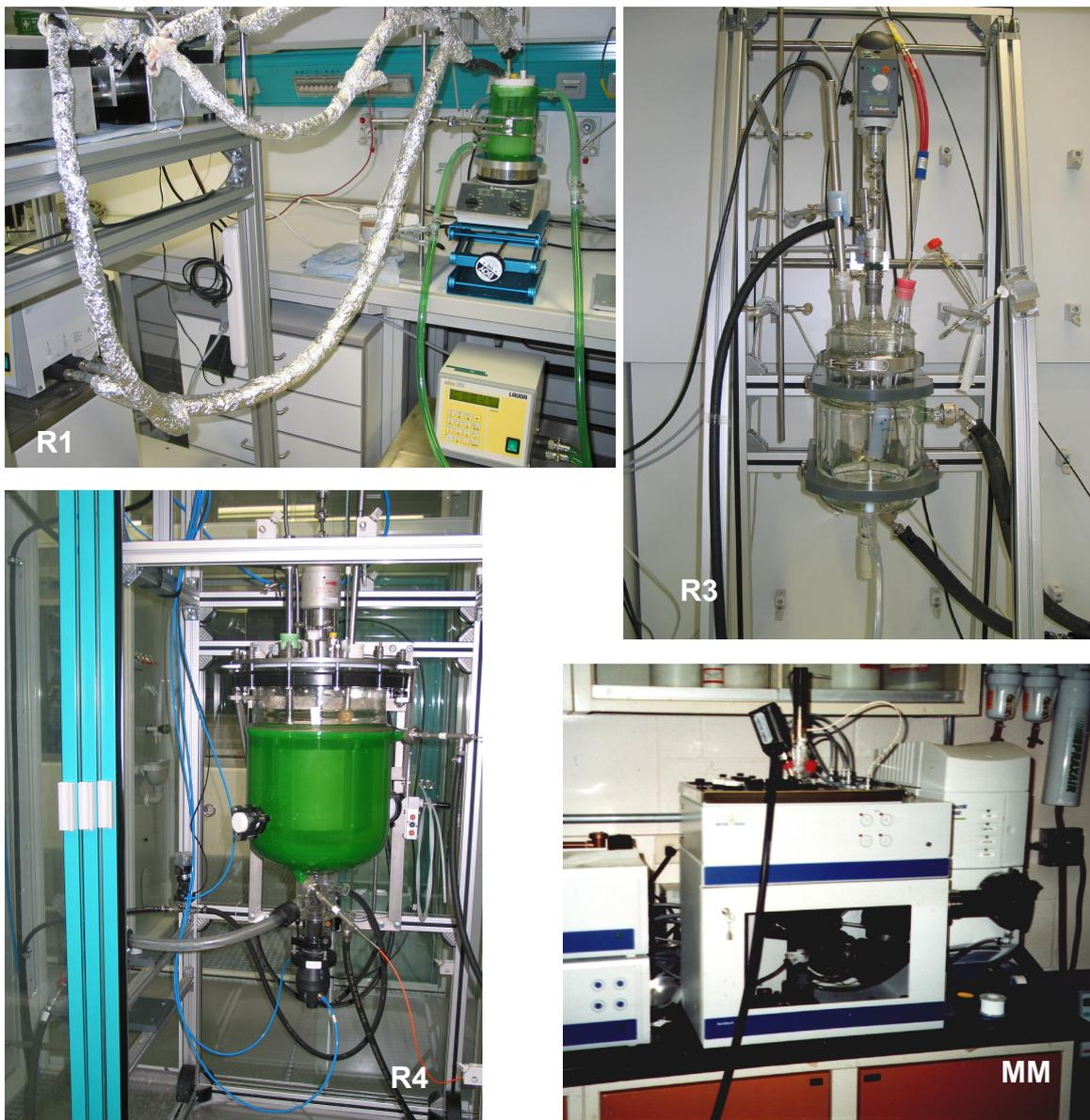
**Abbildung 3.7:** Eingesetzte Kristallisationsreaktoren, oben links - R1, oben rechts – R3, unten links - R4, unten rechts - MM, (R2 entspricht in der Bauart R3, der apparative Aufbau wurde nicht fotografisch festgehalten).
