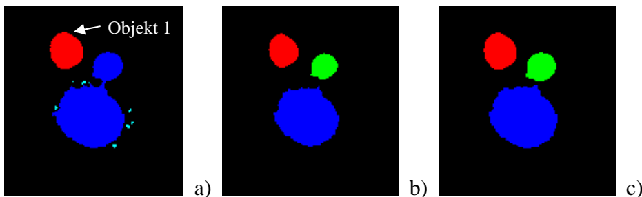
Abbildung 4: a) Binärbild nach fester Schwellenwertoperation. b) Ergebnisbild nach Erosion. c) auf Bild b) angewandte Dilation mit identischem Strukturelement wie bei der Erosion (Opening).
