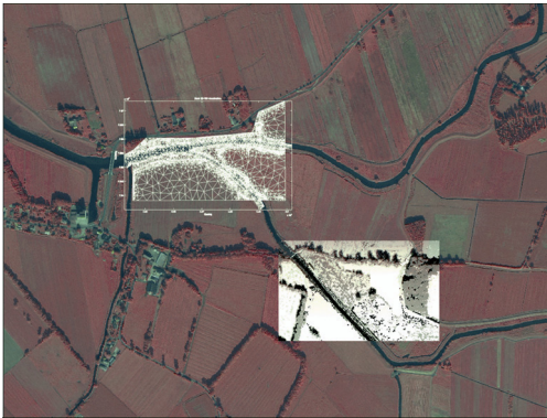
Eingangsdaten für eine Überflutungssimulation: Rauheitsparameter aus einer Rasterbildanalyse und ein digitales Geländemodell (TIN)
