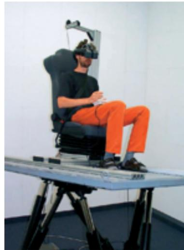
Abb. 1: Versuchsperson auf der Bewegungsplattform. Die Wahrnehmung der Eigenbewegung und das Sehen werden entkoppelt und getrennt voneinander manipuliert. So erhalten die Forscher Rückschlüsse darauf, wie die Welt im Kopf abgebildet wird.
