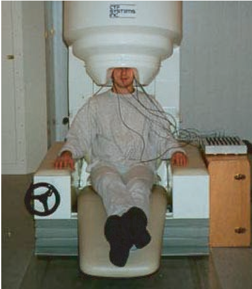
Abbildung 3. Ein heute übliches MEG-System. Im Kühlbehälter sind 151 Sensoren (axiale Gradiometer) angebracht, die den gesamten Kopf abdecken. Die Aufnahmespulen und die SQUIDs sind in flüssiges Helium getaucht, um Supraleitung zu erreichen. Neben der Versuchsperson steht ein 64 Kanal EEG-Vorverstärker, der die gleichzeitige Aufzeichnung des EEGs erlaubt.
