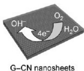
Abbildung 6: Katalytische Wirkung von stickstoffdotierten Graphenfolien bei der O 2 -Reduktion
