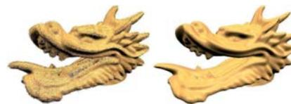
Abbildung 3: Verrauschte Punktdaten vor der Vorarbeitung (links) und eine rekonstruierte Oberfläche nach dem Entrauschvorgang (rechts), (Arbeit von Oliver Schall, SPBG '05)
