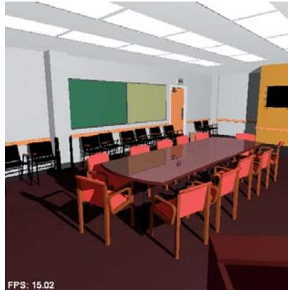
**Abbildung 1:** Mit dem Ray Tracing Verfahren können nun auch auf herkömmlichen Graphikkarten physikalisch korrekte Schatten und Reflexionen in Echtzeit berechnet werden.
