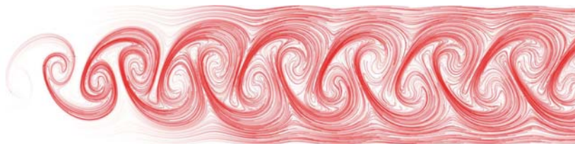
Abbildung 1: Die Streichlinien in der Strömung hinter einem Zylinder stellen – im Gegensatz zu Bahnlinien – klar die Verwirbelungen in der Strömung dar.
