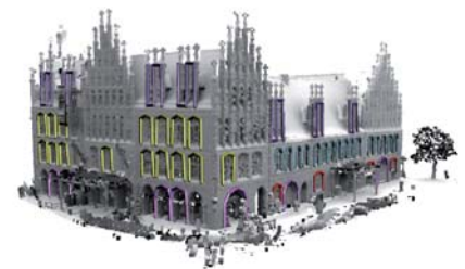
Abbildung 3: Semantische Korrespondenzen, die mit Hilfe maschinellen Lernens aus wenigen Beispielen abgeleitet wurden. Datensatz: IKG Hannover.
