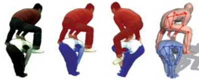
Abbildung 1: Von links nach rechts: Eines von 12 Eingabebildern; segmentierte Eingabebilder; rekonstruierte Skelett- und Oberflächenmodelle.
