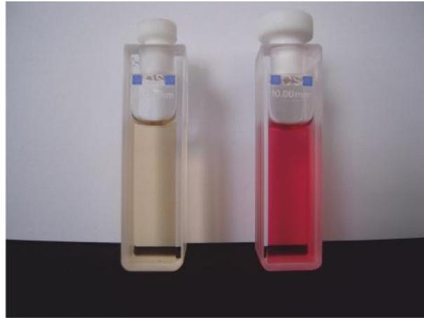
**Abbildung 59: Photochrom in Styrol als offenes Isomer (gelb) und als geschlossenes Isomer nach der UV-Bestrahlung (rot).**
