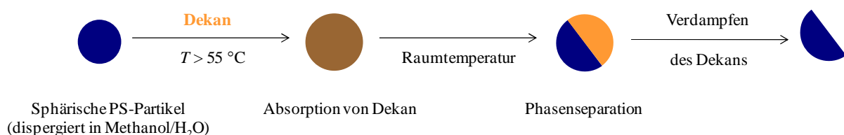
Abbildung 17: Schematische Darstellung der Herstellung halbkugelförmiger PS-Partikel. 80
