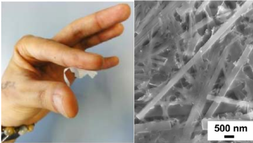
Abb. 11: Rein anorganisches Papier, welches aus eindimensionalen \text{MoO}_3 -Fasern aufgebaut ist und als Elektrodenmaterial in elektrochemischen Zellen eingesetzt werden kann. [29]
