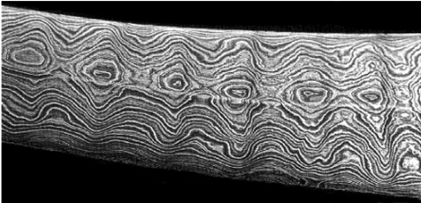
Bild 1.5: Angeätzte Mikrostruktur in einem Schmiedestück aus Damaststahl.
