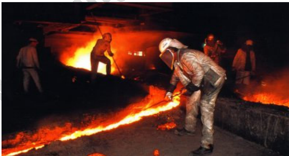
Stahlarbeiter beim Abstich am Hochofen – bis heute einer der härtesten Jobs bei der Herstellung der Metalle.
