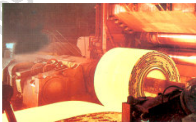
Rostfreier Eisen-Chrom-Nickel-Stahl im Warmwalzwerk.
