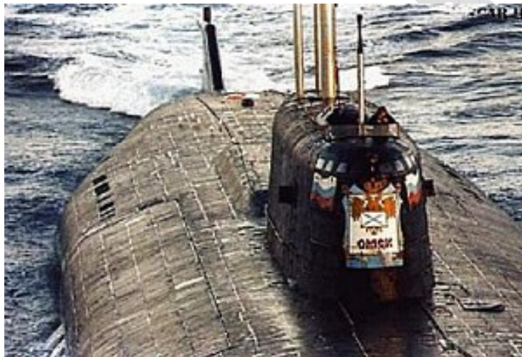
Der Rumpf der russischen Atomunterseeboote der OSCAR II Klasse ist aus einer Titanlegierung gefertigt. Auch die im August 2000 vor Murmansk gesunkene 18.000 Tonnen schwere und 155 Meter lange Kursk gehörte dieser Klasse an.
