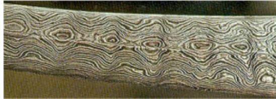
Angeätzte Mikrostruktur in einem Schmiedestück aus Damaststahl.
