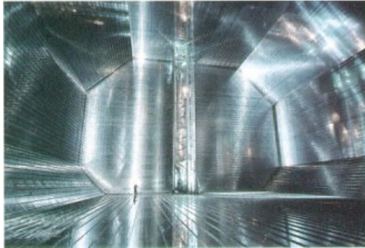
Tankinnenraum aus Invar zum Transport verflüssigter Gase.
