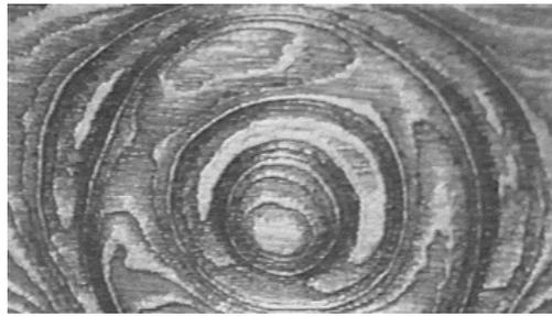
Bild 9.8: Geätztes Muster auf Damaststahl.
