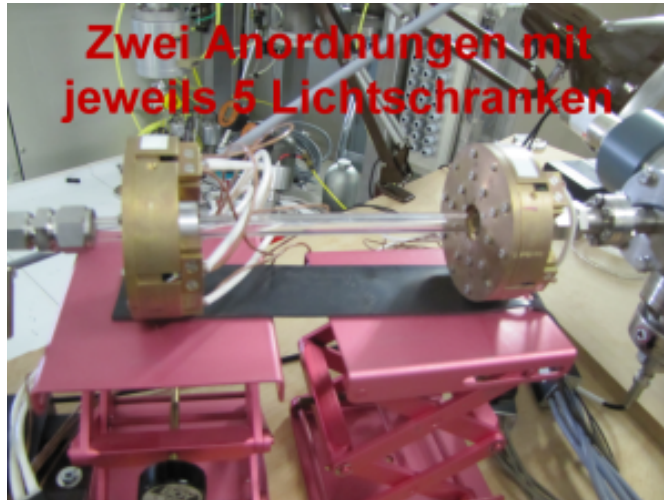
Abbildung 3.9: Die zwei Anordnungen der jeweils fünf Lichtschranken um das Plexiglasrohr nach dem Führungsrohr
