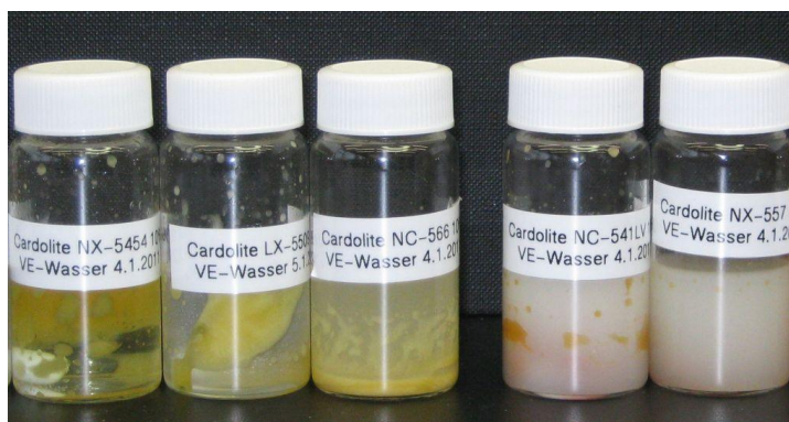
Abbildung 61: Einfache Voruntersuchung zur Wasserlöslichkeit von Aminhärtern durch „Lösen“ der Härter in Wasser (10 Gew.-%). Cardolite NX-5454 (linkes Glas) weist die geringste Wasserlöslichkeit auf. In allen anderen getesteten Systemen erfolgte eine Trübung der Lösung.
