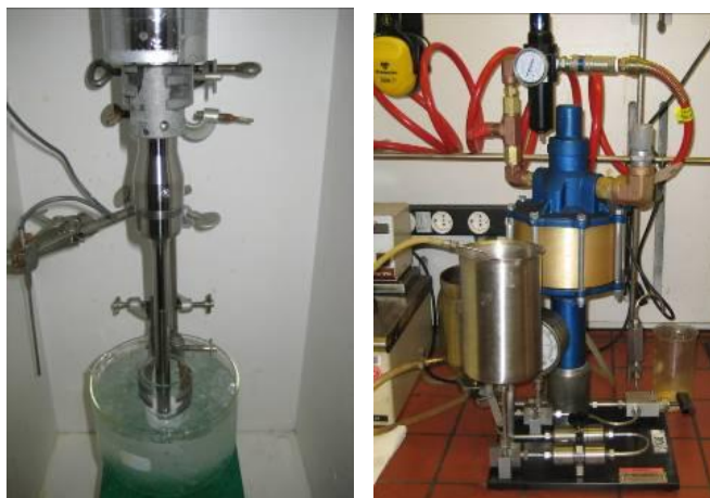
Abbildung 8: Darstellung eines Ultraschallstabs (links) bzw. eines Hochdruckhomogenisators (rechts) zur Erzeugung der für die Herstellung von Miniemulsionen benötigten Scherkräfte.
