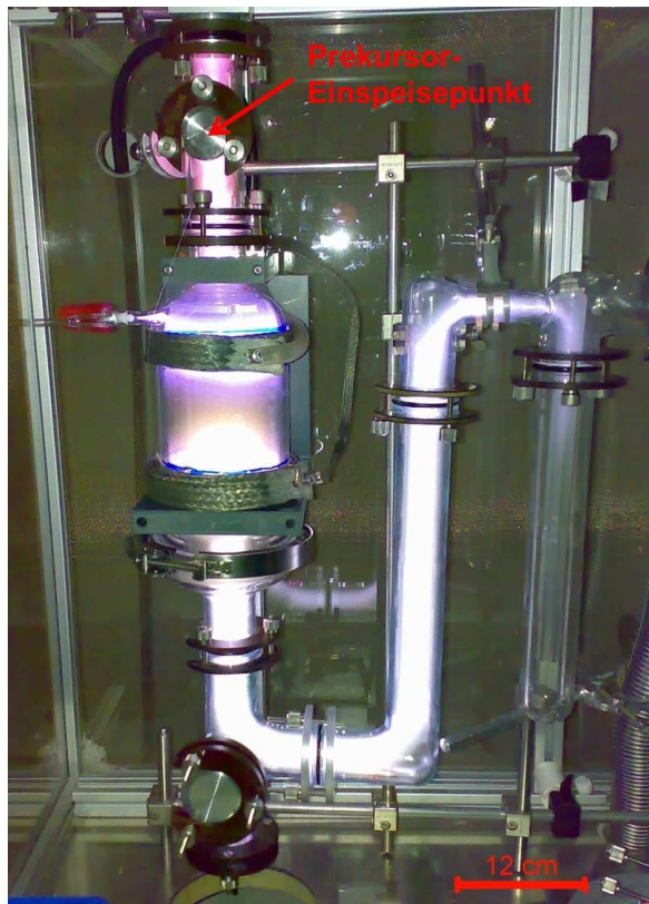
Abb. 5.1: Foto des verwendeten Reaktors mit gezündetem Reinigungsplasma. Der Übersicht halber ist die beheizte Precursorzuleitung auf diesem Bild nicht installiert, der rote Pfeil markiert den Ort der Precursoreinspeisung.
