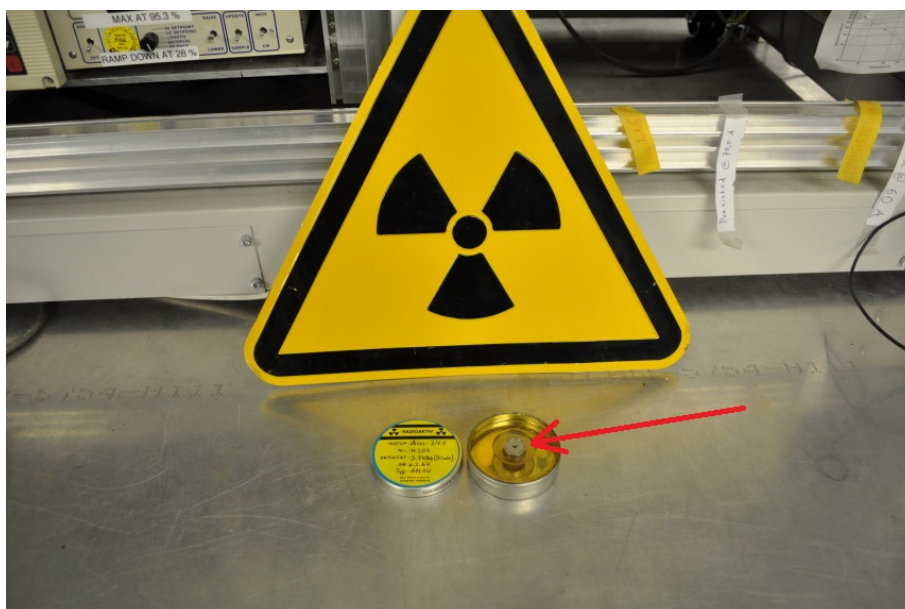
Abbildung 3.14: Kalibrationsquelle des Röntgendetektors, der rote Pfeil zeigt darauf. Material: Am 241 , Aktivität: 3.7 kBq am 6.2.64, physikalische Halbwärtszeit: 432 Jahre, Aktivität Juli'14 ca. 3.4 kBq
