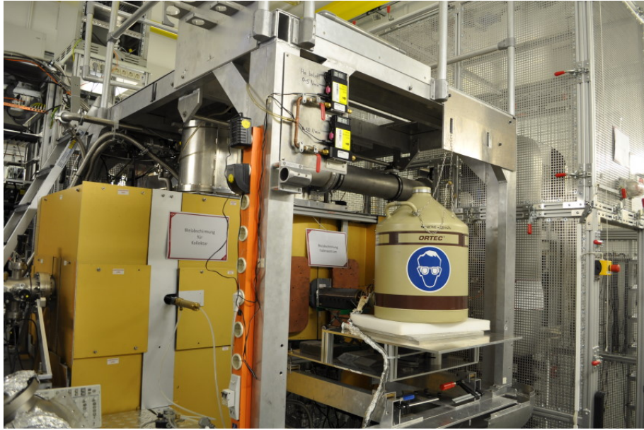
Abbildung 3.4: Die Heidelberg-EBIT. Rechts ist der Faradaysche Käfig der Elektronenkanone zu sehen. Die gelb farbigen Bleiplatten umhüllen das Fallenzentrum der EBIT. Der beige Tank in der Mitte enthält flüssigen Stickstoff, der den Röntgendetektor, der zur Falle hin herausragt, kühlt.
