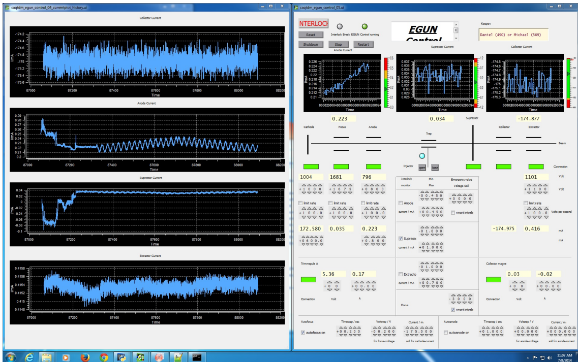
Abbildung 4.4: Screenshot Graphischer Benutzeroberflächen für Historie diverser Ströme für etwa 20 min (links) und Elektronenkanonensteuerung (rechts)
