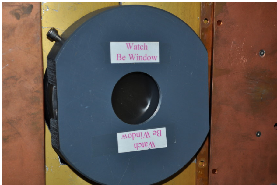
Abbildung 3.13: Berylliumfenster der HD-EBIT. Eine dünne Berylliumfolie trennt das Vakuum der Falle von der Atmosphäre, lässt aber Röntgenphotonen zu Beobachtungszwecke durch.
