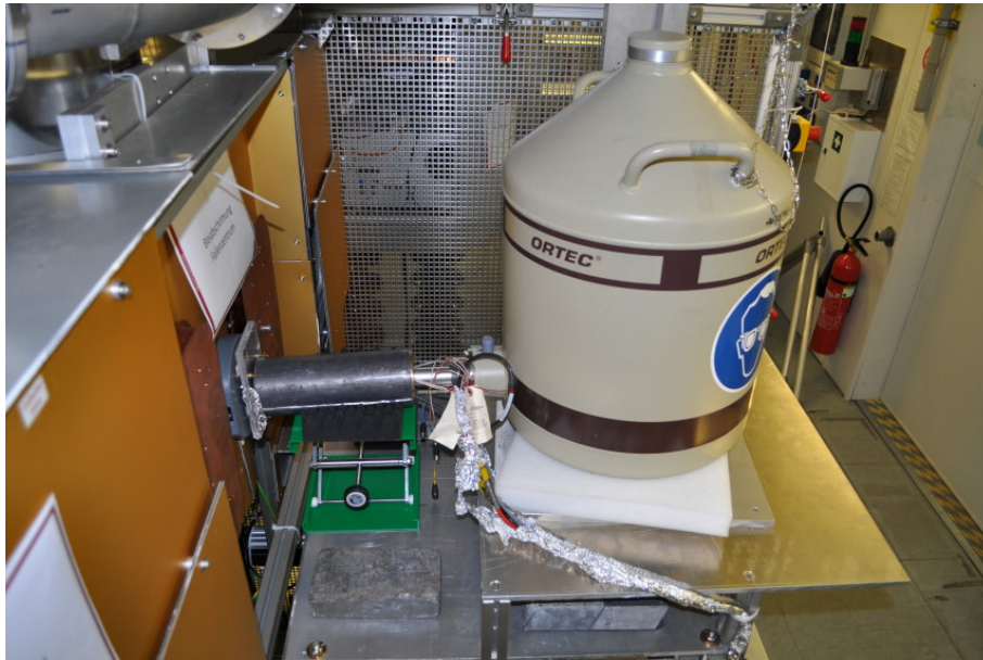
Abbildung 3.11: Röntgendetektor GLP Serie von ORTEC . Er ist direkt vor dem Berylliumfenster der HD-EBIT positioniert und mit Blei und Messing ummantelt. Der Tank enthält flüssigen Stickstoff, der den Detektor kühlt.
