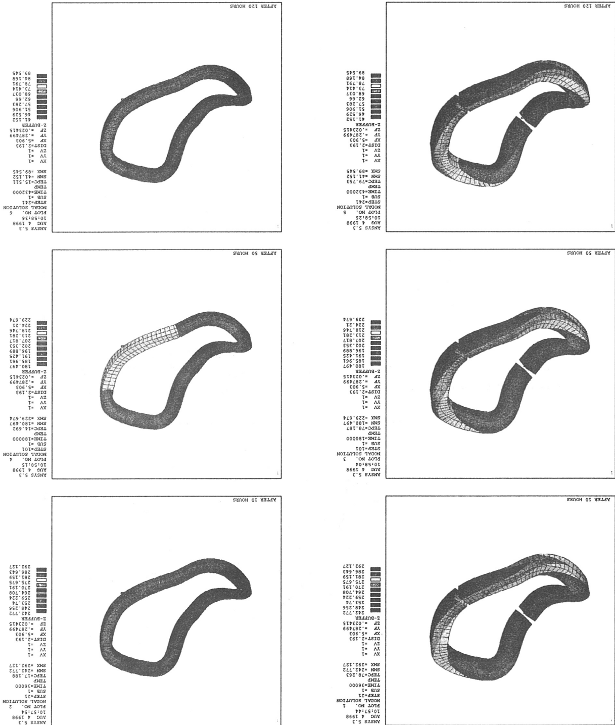
Abbildung 23: Simuliertes Temperaturprofil während der Abkühlung einer MF-Spule mit antiserialer Kühlleiteranordnung entlang des Spulenumfangs nach 10, 50 und 120 Stunden (links: Kupferblechsegmente; rechts: Wickelkörper); Kupferschichtdicke = 1,0 mm
