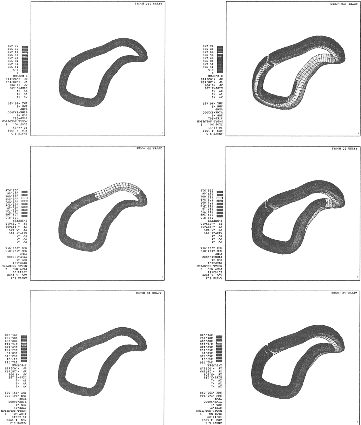
Abbildung 17: Simuliertes Temperaturprofil während der Abkühlung einer MF-Spule mit einem Kühlleiter entlang des Spulenumfangs nach 10, 50 und 120 Stunden (links: Kupferblechsegmente; rechts: Wickelkörper); Kupferschichtdicke = 1,0 mm
