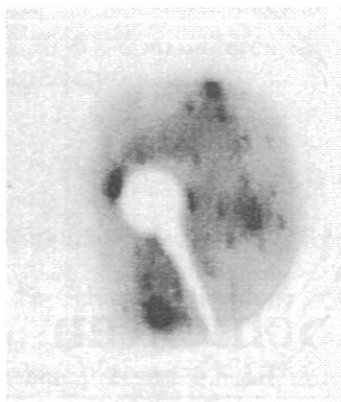
Abbildung 5.11: LEED-Aufnahme der oxidierten \text{FeNi}_3(111) -Oberfläche mit (5 \times 5) -Überstruktur.
