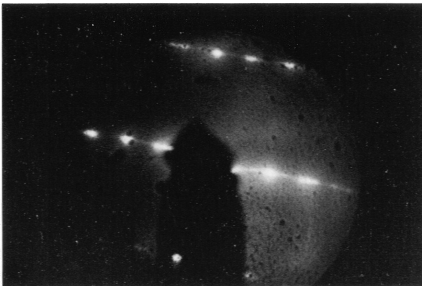
Abb. 3.10 LEED-Aufnahme des einkristallinen Goldtargets: (110)-Fläche mit 2 \times 1 -Überstruktur
