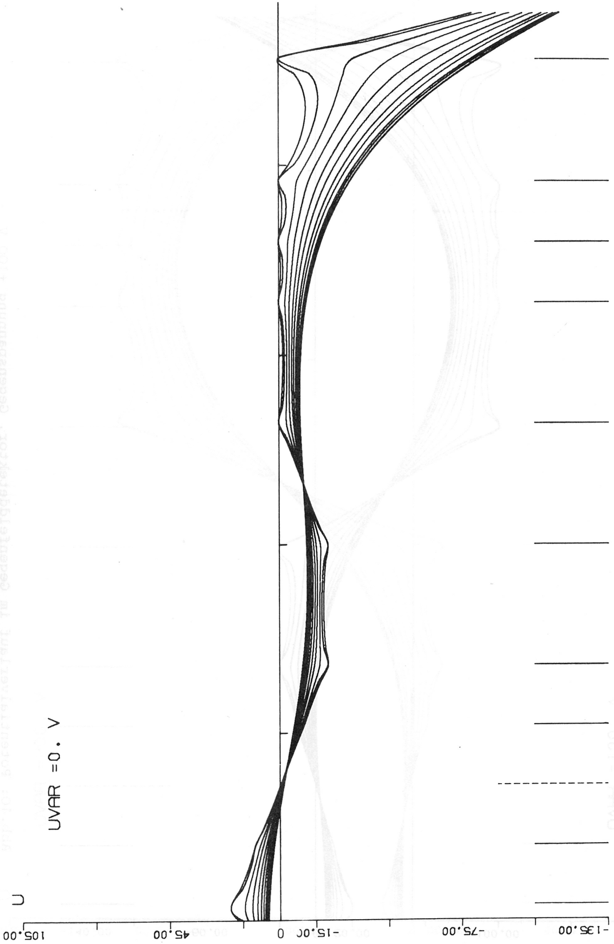
Abb.9: Potentialverlauf im Gegenfelddetektor, Gegenspannung 0 V
