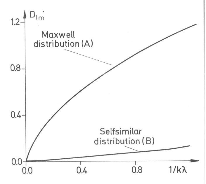
Fig 2. Collisional Modification of Dielectric Constant. Im  $\varepsilon_e=(1+D_{lm})$  Im  $\varepsilon_e^o=(1+D_{lm})$  Im  $\varepsilon_e^o=(1+D_{lm})$  Re  $\varepsilon_e^o=(1-D_{Re})$  Re  $\varepsilon_e^o=($
