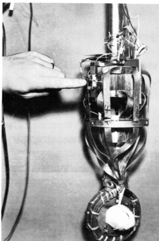
Fig. 23 Beispiel einer rotierenden Flusspumpe für 12 kA (Ref.49)
