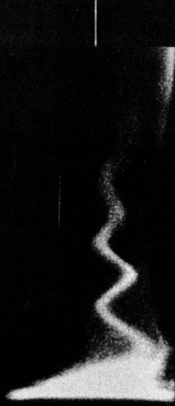
Abb. 7 Schmierbilder von Entladungen mit  $\Delta t_{z,s} = 0$
