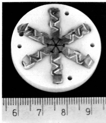
Fig. 5 Elektrodenhalterung der Sechsdrahröhre
