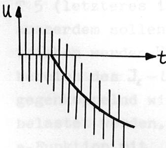
genug ins Negative reicht triggert dann den monostabilen Multivibrator, der die Signalformstufe für die maximal nötige Zeit aufsteuert. Durch diese Synchronisation wird vermieden, dass das erste unter  $-45^\circ$  verlaufende Signalstück unterschiedliche Amplituden hat.
