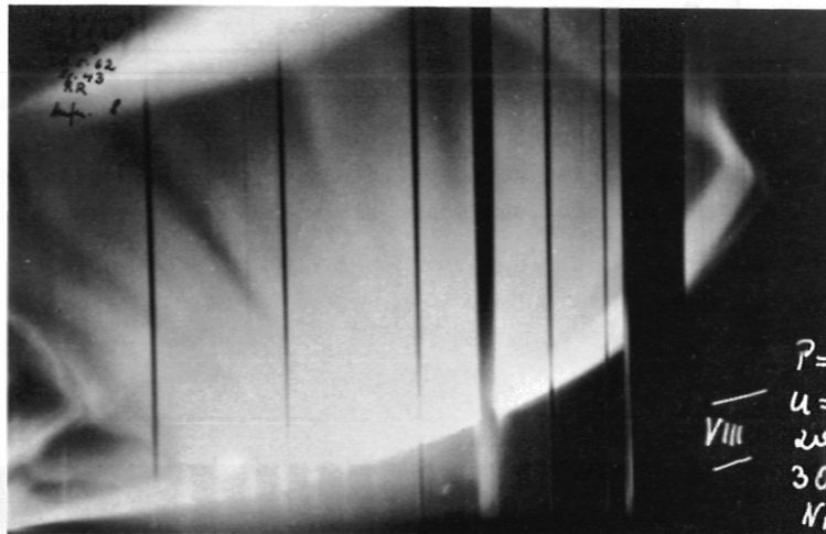
Abb. 10: Schmierfoto einer Stosswelle in Wasserstoff ( p_0 = 2,5 Torr). Inhomogenitäten im Plasma lassen den Strömungsverlauf erkennen.
