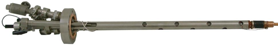
Abbildung 3.8: Die Clusterquelle: Am CF63 Flansch sind Ankopplungen für die LHe Kühlung, das Clustergas, die Temperaturmessung und -regelung sowie ein durch die Düse scheinender Laser vorhanden.
