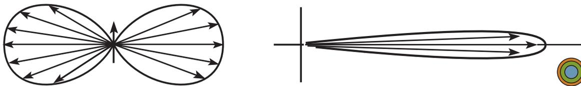
Abbildung 3.1: Synchrotronstrahlung im Ruhesystem des Elektrons (links) und im Laborsystem (rechts). Durch relativistische Effekte ist die Synchrotronstrahlung stark blauverschoben und in Vorwärtsrichtung gebündelt. Illustration mit freundlicher Genehmigung von David Attwood [50, 51].
