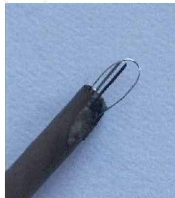
Abbildung 4.13: Sondenarray aus zwei Langmuir-Sonden (Wolframdraht, d = 200 \text{ }\mu\text{m} , l = 3 \text{ mm} ) und einer Wolfram-Glühschleife ( d = 100 \text{ }\mu\text{m} , u = 10 \text{ mm} ).
