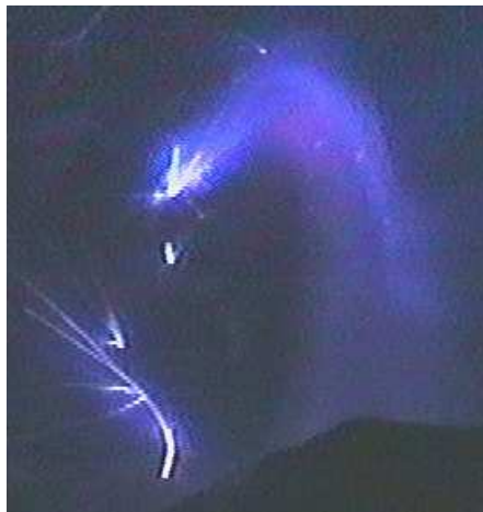
Abbildung 3.6: Entladung #56922, Videobild 1158, toroidale Sicht in das W7-AS Plasma. Zu sehen ist das bläulich-violette Leuchten eines \text{LaB}_6 -Stücks und starker Funkenflug. Die Sonde ist verdeckt.
