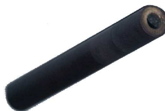
Abbildung 3.8: Foto der indirekt heizbaren \text{LaB}_6 -Sonde. Maße: Länge 50 mm, Außendurchmesser 6 mm, Innendurchmesser 2.7 mm
