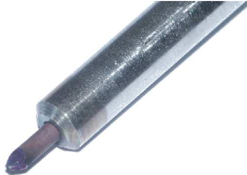
Abbildung 3.7: Verwendete \text{LaB}_6 -Spitze nach dem Einsatz im W7-AS Plasma. Die Erosionsspuren der ursprünglich zylindrischen Spitze sind deutlich sichtbar.
