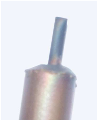
Abbildung 4.12: LaB 6 -Spitze (klein) für den Einsatz in der VINETA. Die Aufnahme wurde nach Gebrauch gemacht.
