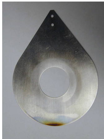
Abbildung 3.21: Lochmaske. Innerer Durchmesser 35 mm, äußerer Durchmesser 100 mm.
