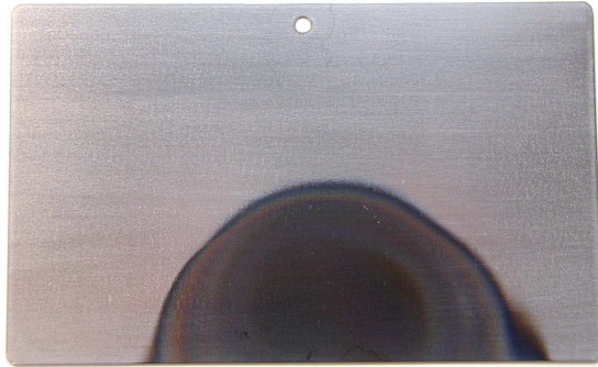
Abbildung 3.20: Halbmaske. Kantenlänge 120 bzw. 80 mm. Die halbkreisähnliche Struktur auf der Maske ist durch Auswirkungen des Plasmas entstanden.
