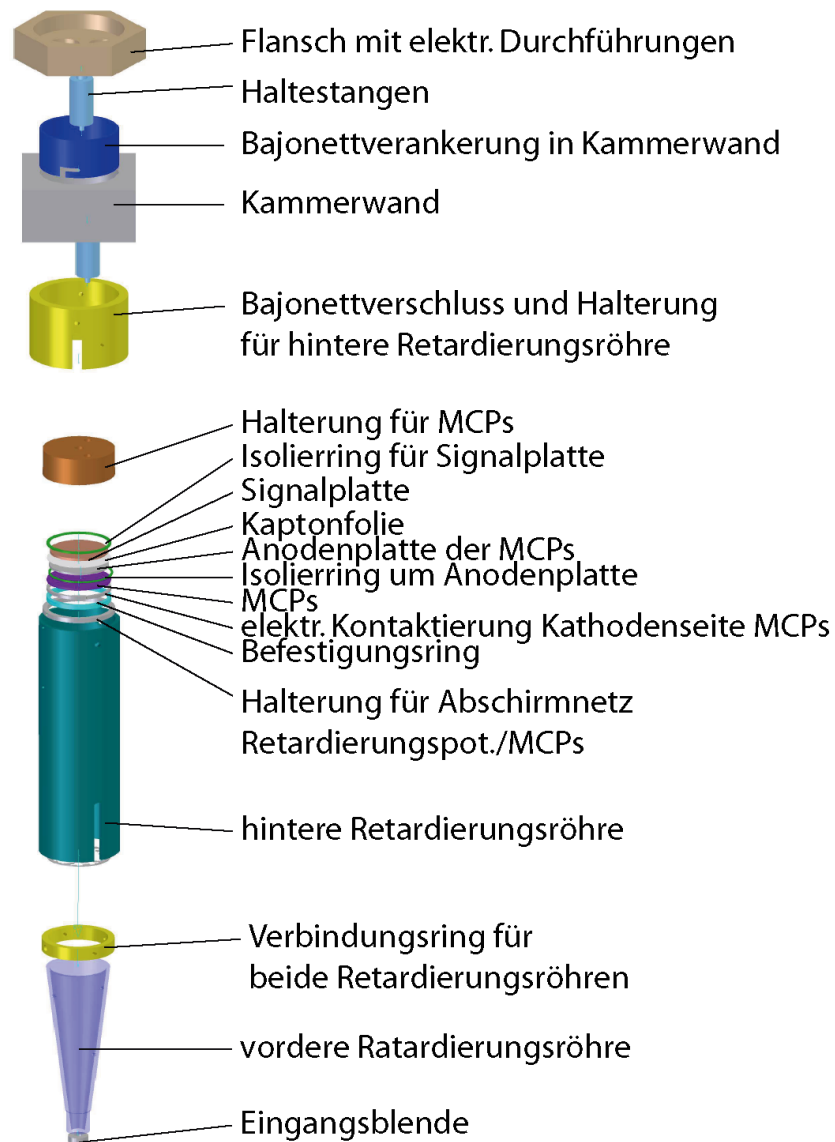
Abbildung 9.2: Explosionsdarstellung eines Flugzeitspektrometers.
