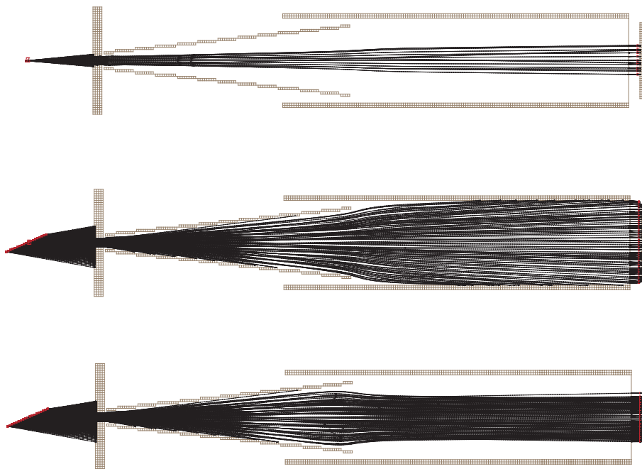
Abbildung 3.10: Simulation der Trajektorien in einem Flugzeitspektrometer mit 125 mm langer hinterer Retardierungsstrecke zur Veranschaulichung der elektrostatischen Linseneffekte. Bei den tatsächlichen Messungen wurde diese Strecke um 40 mm verkürzt. Oben: Punktquelle mit Retardierungsspannungen U_{vorn}/U_{hinten} = -9\text{ V} / -15\text{ V} . Mitte: gleiche Retardierungsspannungen für ein linienförmiges (realistisches) Wechselwirkungszentrum unter einem Sichtwinkel von 66^\circ (zu erkennen an der Neigung des linken Endes der Trajektorien). Unten: Linseneffekt bei U_{vorn}/U_{hinten} = -9\text{ V} / +15\text{ V} für ein linienförmiges Wechselwirkungszentrum unter 66^\circ .
