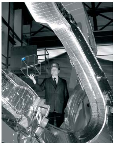
Lutz Wegener leitet die Montage von Wendelstein 7-X. Der weltgrößte Stellarator wird aus mehr als einer Million Einzelteilen bestehen, darunter 70 große supraleitende Spulen, die das Plasma berührungslos einschließen.
