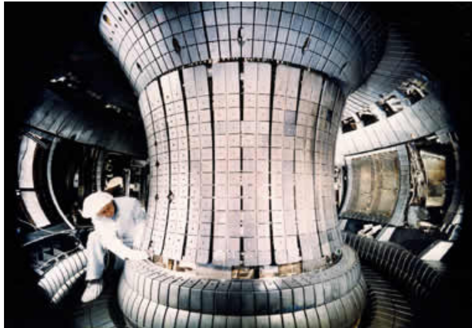
Abbildung 9: Das Innere des ASDEX Upgrade während der Umbauphase in noch nicht vollständig montiertem Zustand (Abbildung IPP)
